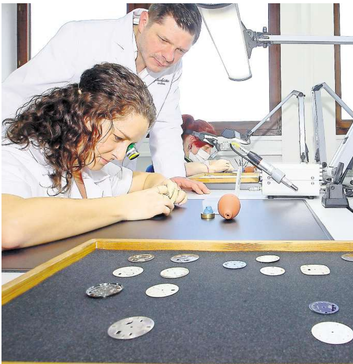
Qualitätskontrolle und viel Handarbeit sind erforderlich, um hochwertige Zifferblätter zu fertigen (von links): Jennifer Böhnler, Produktionsleiter Tim Müller und Anja van der Linde. FOTOS: SEIBEL
